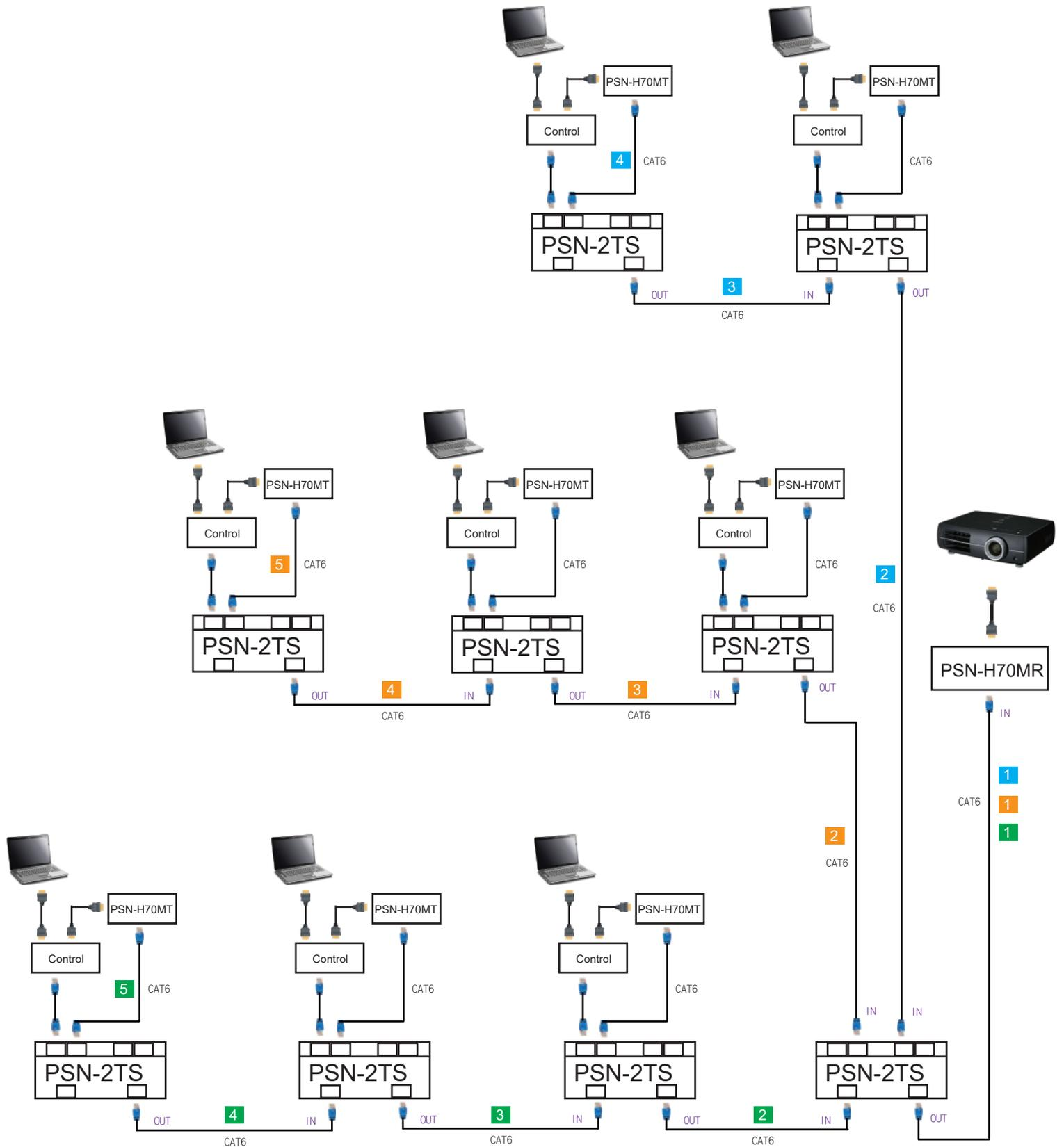
系統總長距離計算: 1 + 2 + 3 + 4 例: ( 20m+20m+5m+2m ) = 47m
