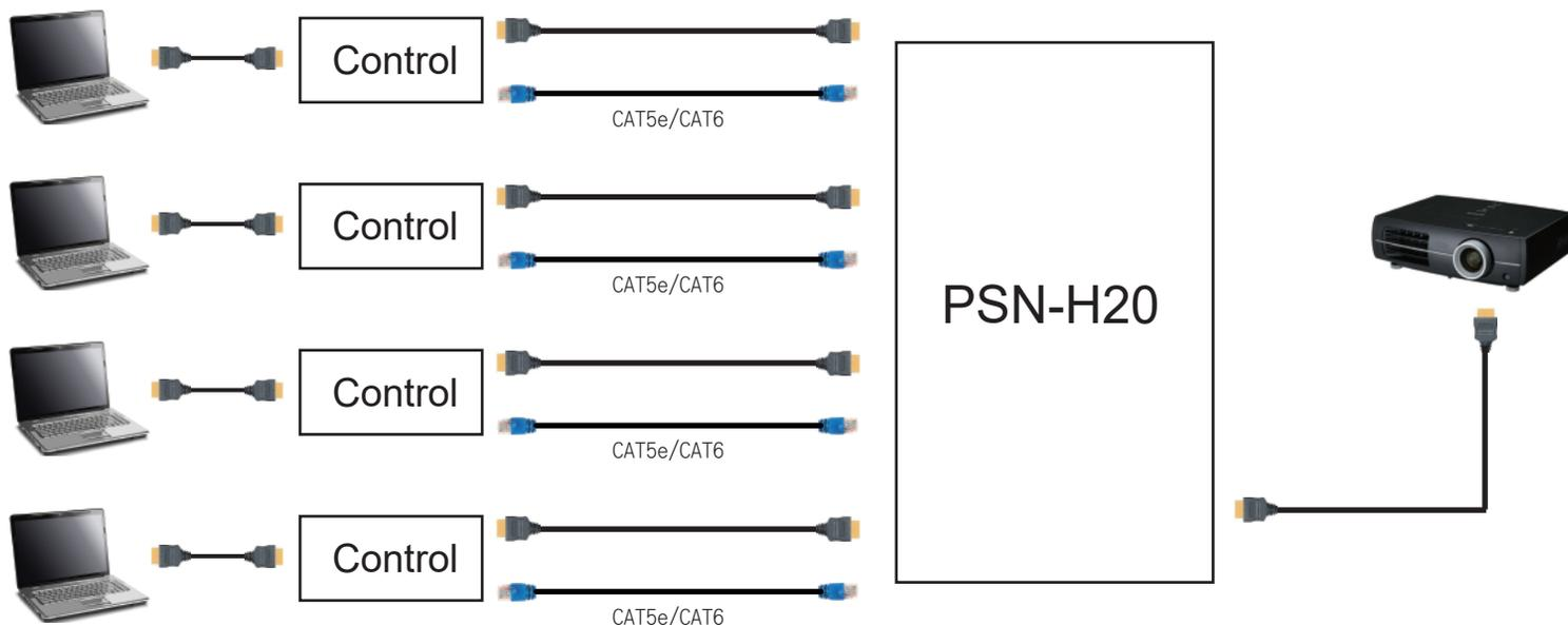
PSN-H20 輸出埠搭配 HS01N 可透過 CAT6 網路線將 HDMI 輸出距離做延長，最遠 40 公尺
